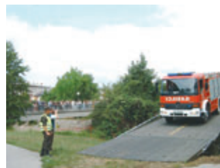
Sodelovanje z gasilci je zgledno (prehod gasilskega vozila preko lansirnega mostu »Eurobridge«)
