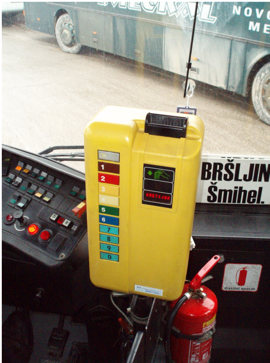
Slika 7: komunikacijska enota sistema Prodato za nadzor nad potniškimi tokovi. Potnik se z magnetno vozovnico evidentira ob vstopu na avtobus
