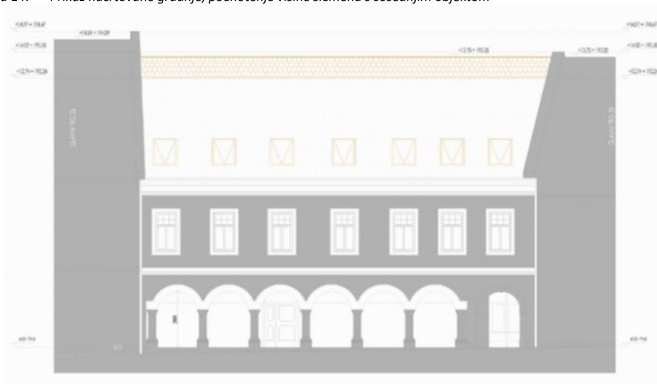
Slika 14: Prikaz načrtovane gradnje, poenotenje višine slemena s sosednjim objektom
